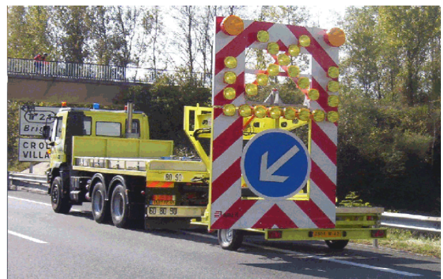
FLR déportée – crédits photo AREA
